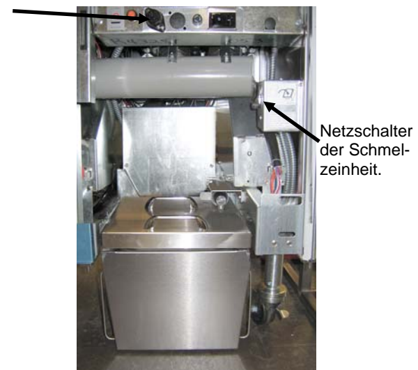
Abb. 7: Die zusammengebaute Schmelzeinheit wird in ihrer Einbauposition gezeigt.
