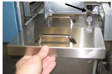
Abb. 4: Den Deckel auf die Wanne setzen und das Ölabsaugrohr in die Buchse des Absaugbehälters schieben.
