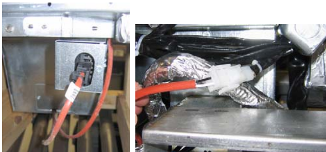
Abb. 6: Den weißen 2-poligen Stecker befestigen und den schwarzen Stecker an die Netzdose anschließen. * Bitte beachten, dass der schwarze Stecker anders als auf dem Foto aussehen kann.
