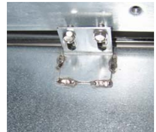
Abb. 5: Die Schmelzeinheit auf beiden Seiten an den Schienen befestigen.
