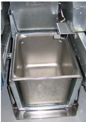
Abb. 3: Die innere Öltankwanne in die Schmelzeinheit einsetzen.
